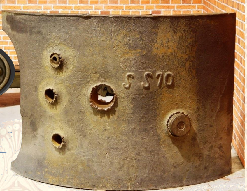
8 cm silná nastřelená pancéřová deska z VHHT ve sbírkách VHÚ Praha/VTM Lešany
