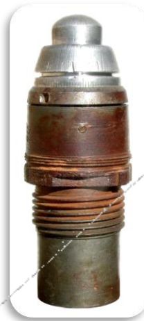
Časový zapalovač T-90 Foto B. Zamazal
